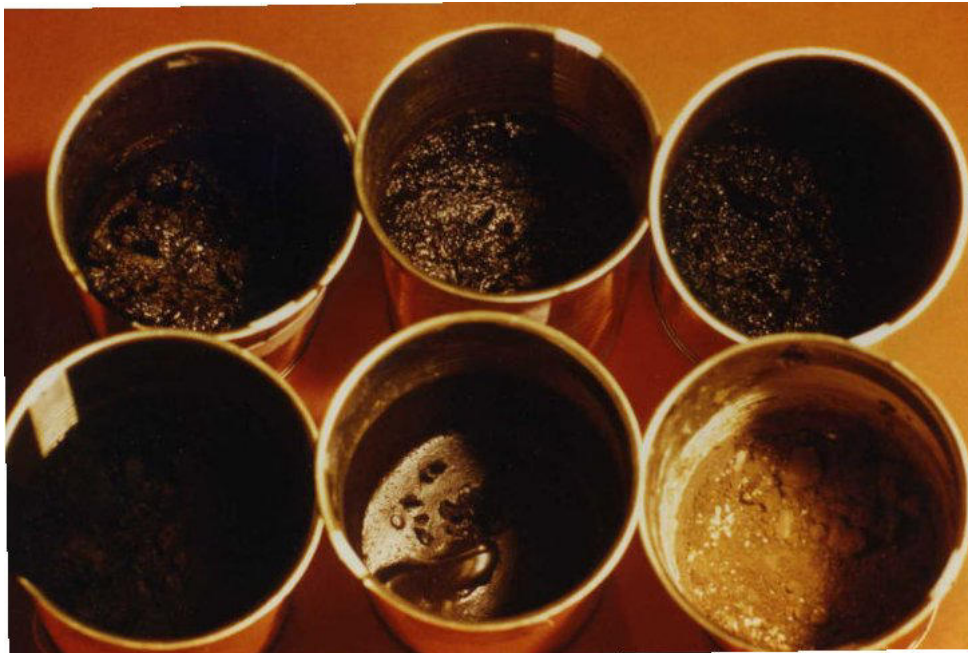
Bild 13: Verfestigungsprodukte mit anionischer Bitumenemulsion mit folgenden Zuschlagstoffen: im Vordergrund von links nach rechts Braunkohlestaub, Heidelberger Schnellzement, Weißfeinkalk; im Hintergrund Weißkalkhydrat, Trinidad Asphalt I, Feinstkoks.
