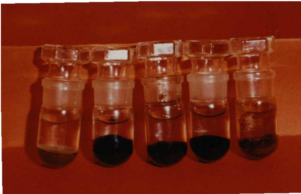
Bild 21: Wasserschütteltest an Verfestigungsprodukten mit organischen Zuschlagstoffen und Zuschlagstoffkombinationen, Zuschlagstoffe von links nach rechts: Trinidad Asphalt II, Feinstkoks, Trockenbraunkohle/Braunkohlestaub (80/20), Feinstkoks/Braunkohlestaub (50/50), Trinidad Asphalt I/Braunkohlestaub (80/20). Es tritt kaum Öl aus.
