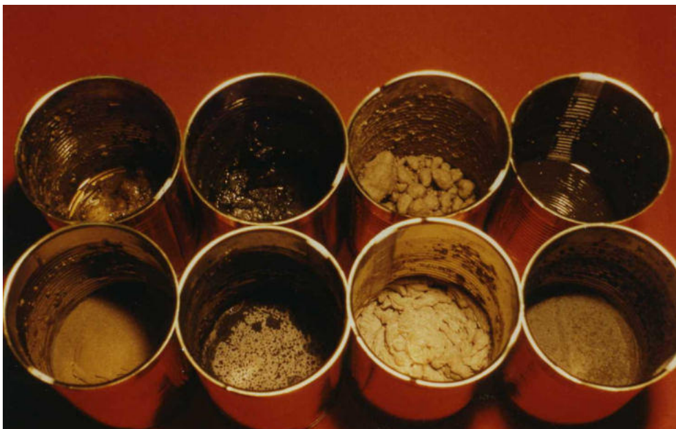
Bild 11: Verfestigungsprodukte mit anorganischen Bindemitteln unter Zusatz von Wasser, im Vordergrund Wasser/Feststoff-Verhältnis 1:2, im Hintergrund 1:3. Zuschlagstoffe von links nach rechts: Heidelberger Schnellzement, Hochofenmehl/REA Flugasche II (50/50), Gips und Portlandzement.
