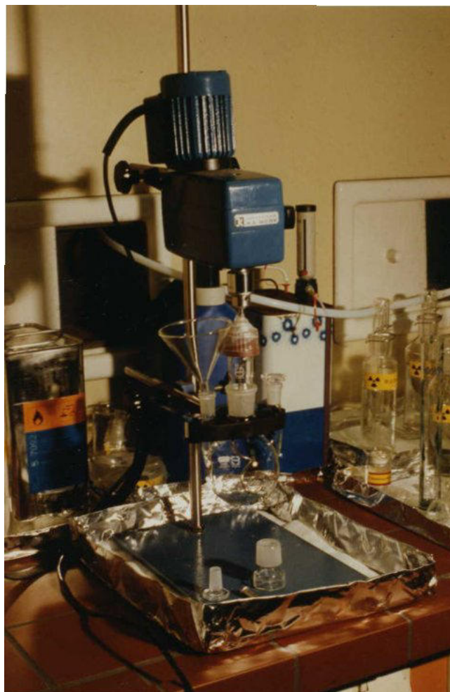
Bild 8: Mischapparatur für Verfestigungsversuche mit schadstoffbelastetem Testöl.
