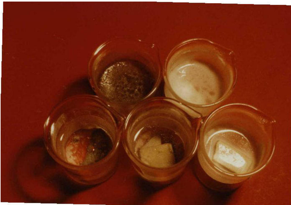
Bild 22: Ölaustritt aus Verfestigungsprodukten mit anorganischen Bindemitteln unter Zusatz von Tensiden in Wasser; auf der Wasseroberfläche sind deutlich Öltröpfchen zu erkennen. Im Vordergrund von links nach rechts: Portlandzement, Heidelberger Schnellzement, Gips; im Hintergrund REA Flugasche I, Hochofenmehl/Gips (50/50).
