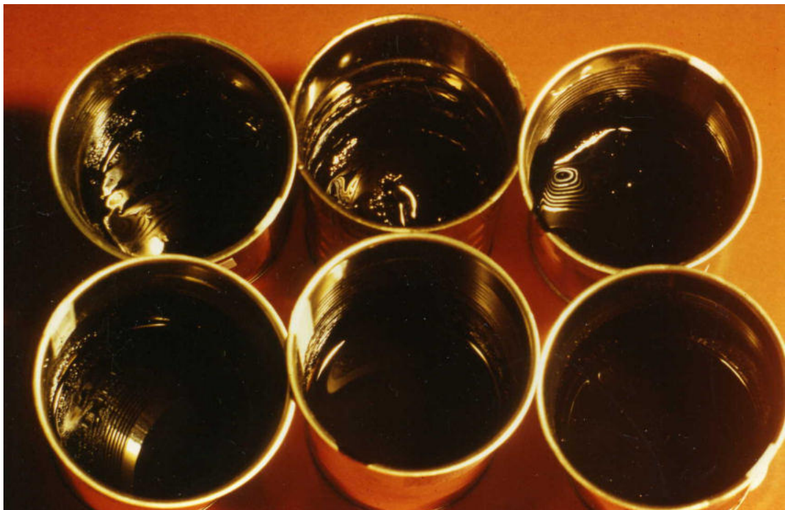
Bild 7: In Dosen angemischte und gelagerte Verfestigungsprodukte mit anionischer Bitumenemulsion.
