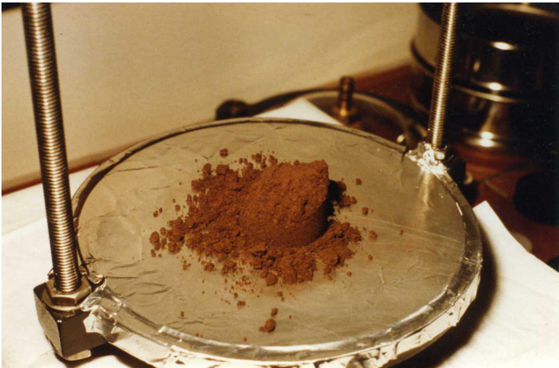
Bild 17: Verfestigungskörper mit 75 Gew.-% Trinidad Asphalt I nach Schütteln.
