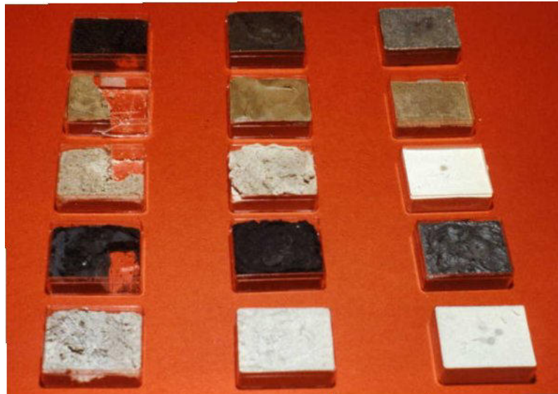
Bild 12: Verfestigungsprodukte mit anorganischen Bindemitteln unter Zusatz von Wasser und Tensiden, Reihenfolge der Zuschlagstoffe von vorn nach hinten: Hochofenmehl/Gips (50/50), REA Flugasche I, Gips, Heidelberger Schnellzement und Portlandzement. Tenside von links nach rechts jeweils DBS, TWEEN 80, CTAB.
