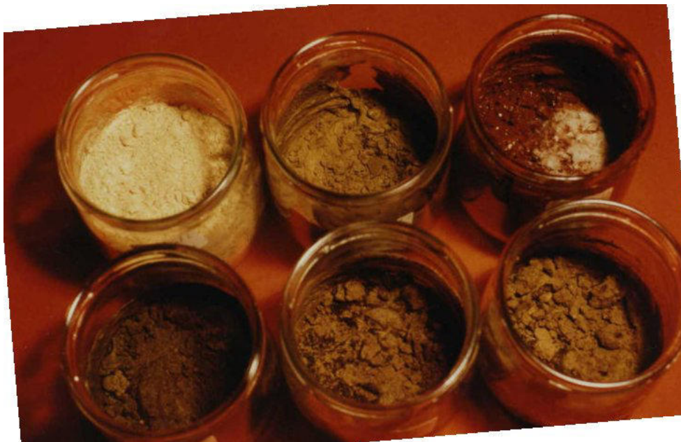
Bild 14: Verfestigungsprodukte mit anorganischen Bindemitteln unter Zusatz von 0,7 Gew.-% kationischer Bitumenemulsion. Im Vordergrund von links nach rechts Portlandzement, Gips, Hochofenmehl/Gips (50/50); im Hintergrund Weißfeinkalk, Heidelberger Schnellzement, Rotschlamm + 5 % Weißfeinkalk.
