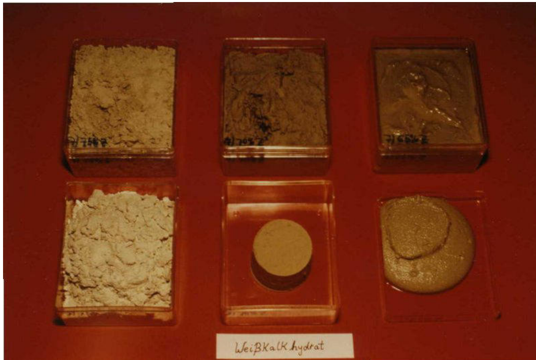
Bild 9: Verfestigungsprodukte mit 75, 70 und 65 Gew.-% Weißkalkhydrat.
