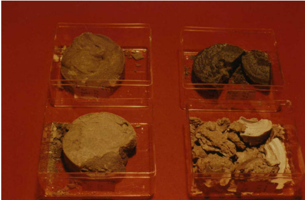
Bild 10: Verfestigungsprodukte mit anorganischen Bindemitteln unter Zusatz von Wasser, Wasser/Feststoff-Verhältnis 1:2, im Vordergrund von links nach rechts: Portlandzement, Gips, im Hintergrund von links nach rechts: Heidelberger Schnellzement, Hochofenmehl/REA Flugasche (50/50).
